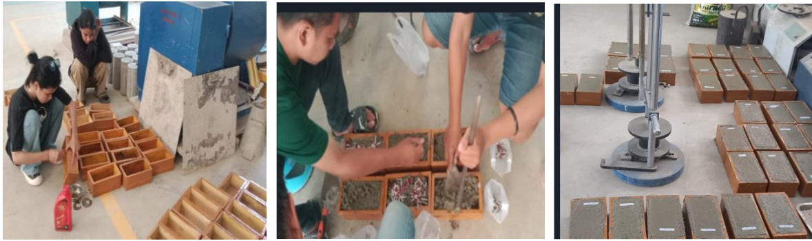
Gambar 4. Proses pencetakan Paving Blok dan Batako
